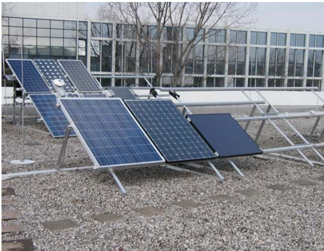
Abb. 1: Teststand zur Energieertragsmessung der PV-Module (Südausrichtung, Neigungswinkel 35^\circ )
