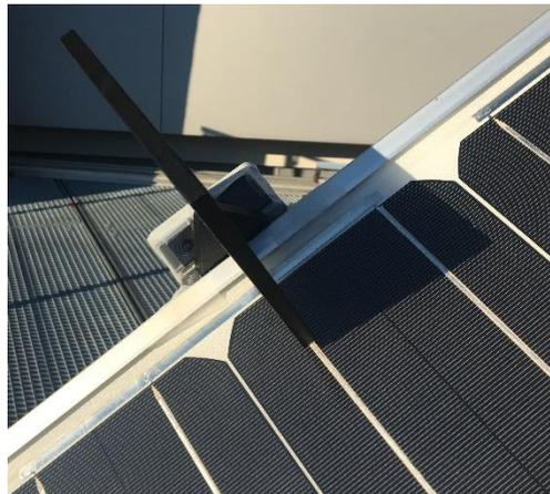
Abbildung 6-3: Photoresistoren mit einer schwarzen Abschirmung aus Holz zwischen und getöntem Plexiglas vor den Sensoren, in einem Gehäuse an der Stirnseite des Solarmoduls zur Erfassung der Einstrahlungswerte.
