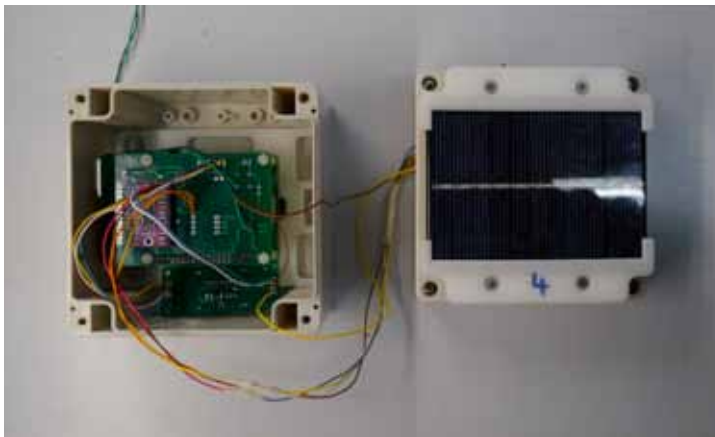
Abb. 10: Der vom SeV bereitgestellte Bausatz für das Projekt Wetterstation in geöffnetem Zustand mit dem Einplatinencomputer Raspberry Pi
