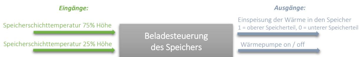
Abbildung 3.5: Black-Box-Modell der Beladesteuerung des Speichers
