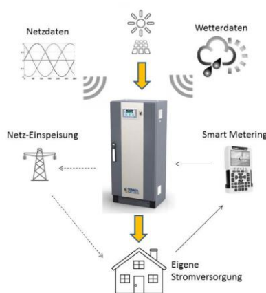
Abbildung 1: Funktionsweise des Heimspeichers
