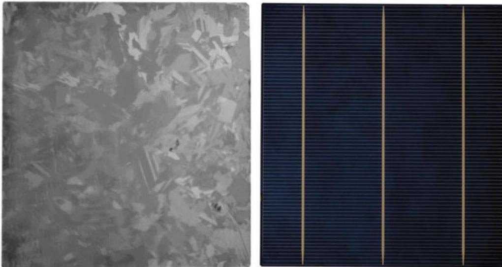
Abbildung 3: Solarzelle mit (rechts) und ohne (links) Reflexionsbeschichtung und Kontaktfinger
