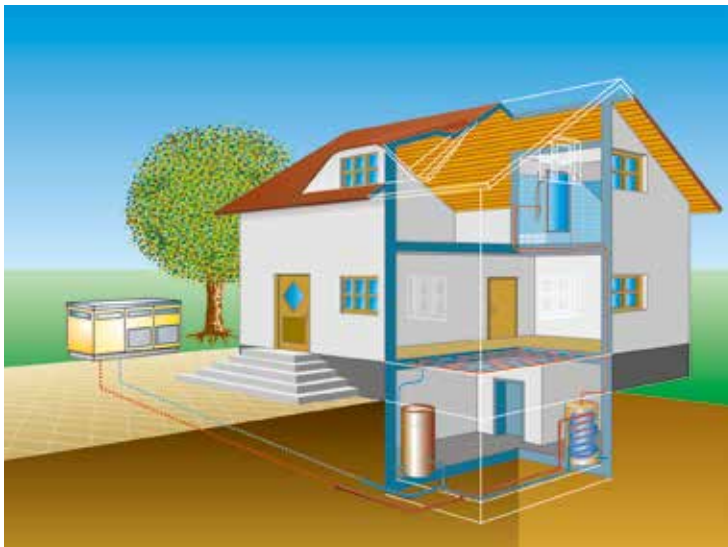
Abb. 10: Praktischer Aufbau einer Luft/Wasser-Wärmepumpe mit außenstehendem Verdampfer und Verdichter sowie innen befindlichem Verflüssiger und einem Speicher für das erzeugte Warmwasser
