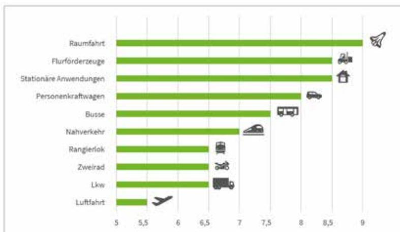
Abb. 12: Technology Readiness Level (TRL) von Wasserstoffanwendungen
